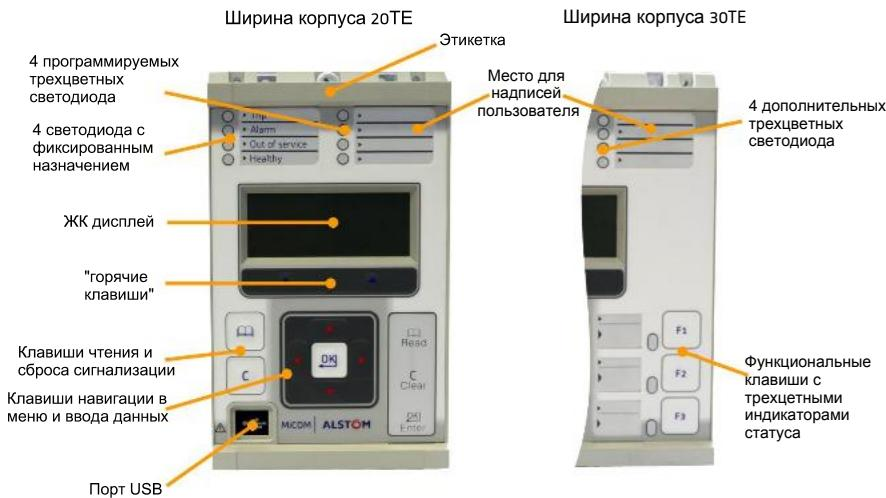
Рис. 1 Интерфейс передней панели устройства Agile
