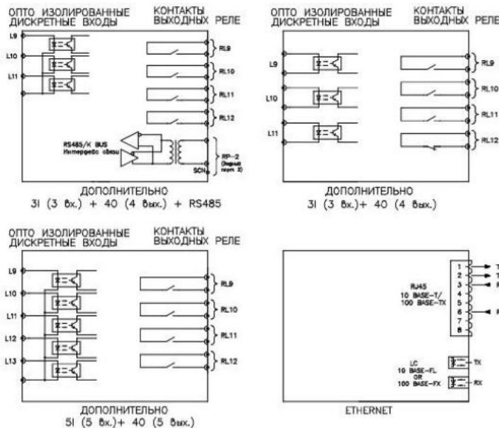
Рис. 4 Пример аппаратных опций доступных в корпусе шириной 30TE
